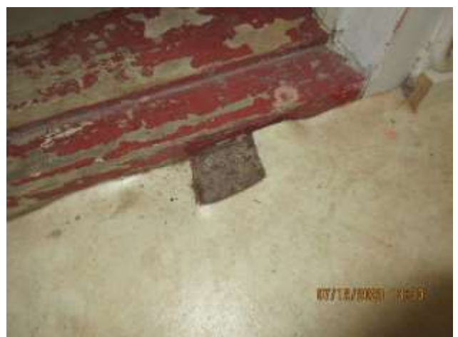
36. Näyte 14. Muovimatto + pohja, I. krs, takkahuone lattia
