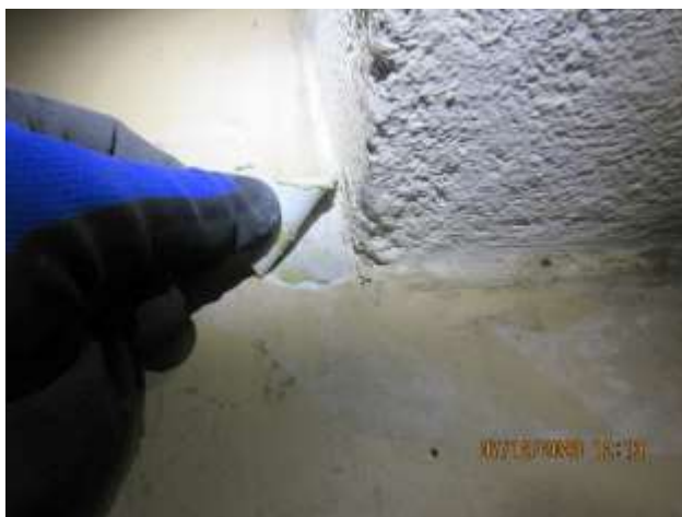
17. Näyte 7. Toisen kerroksen toimistotila muovimattoa, tasoitetta ja musta-liima
